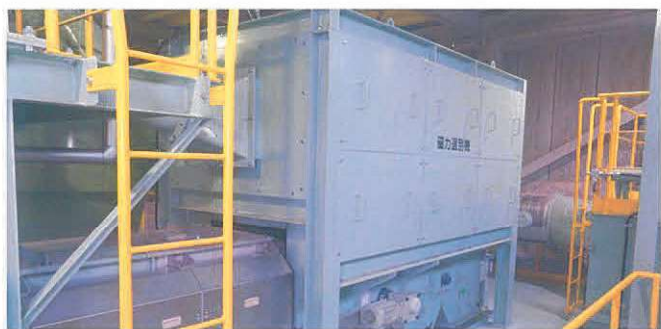
11 磁力選別機 電磁石を使って破砕物の中から鉄類を取り出すものです。
