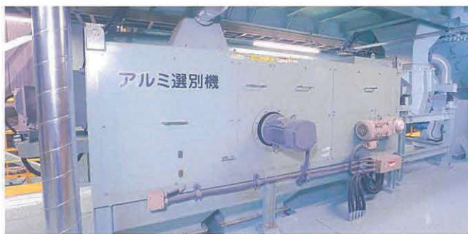
12 アルミ選別機 うず電流により破砕物の中からアルミ類を取り出すものです。
