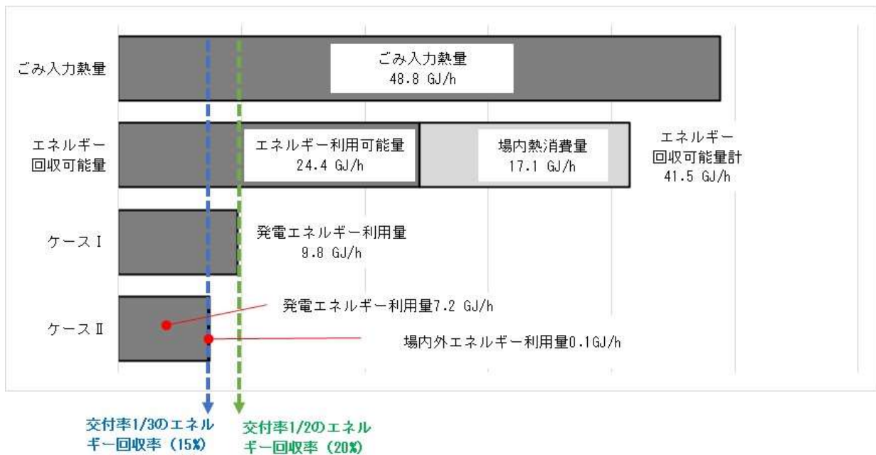
図 4.7 新たなごみ処理施設におけるエネルギー回収量試算（2 炉運転時）
