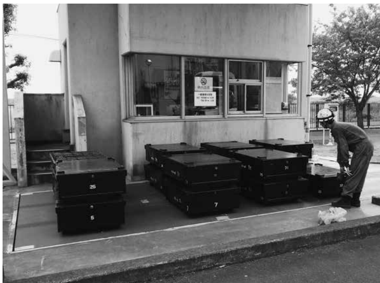
【写真1】法定の重りを均等に載せて検査
