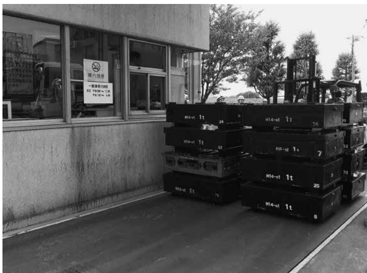
【写真2】法定の重りを片側に載せて検査
